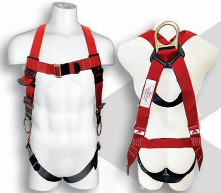
Arnés fabricado en tejido poliéster y anillos de acero de aleación. Viene con 5 puntos de ajuste y fácil uso para mejor ajuste de piernas, cuenta con 3 argollas de "D" para detención de caídas y posicionamiento.
