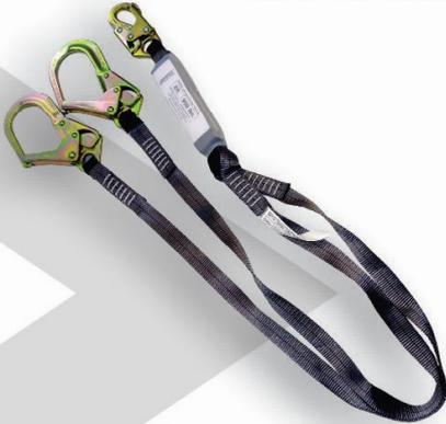
Línea de vida con amortiguador, cinta de 1" y 180cm de largo, fabricada en robusto tejido poliéster resistente a los rayos UV y mosquetones grandes a los extremos (2). Diseño exclusivo ViewPack que combina etiquetas cubiertas con ventana para inspeccionar el amortiguador de energía.
